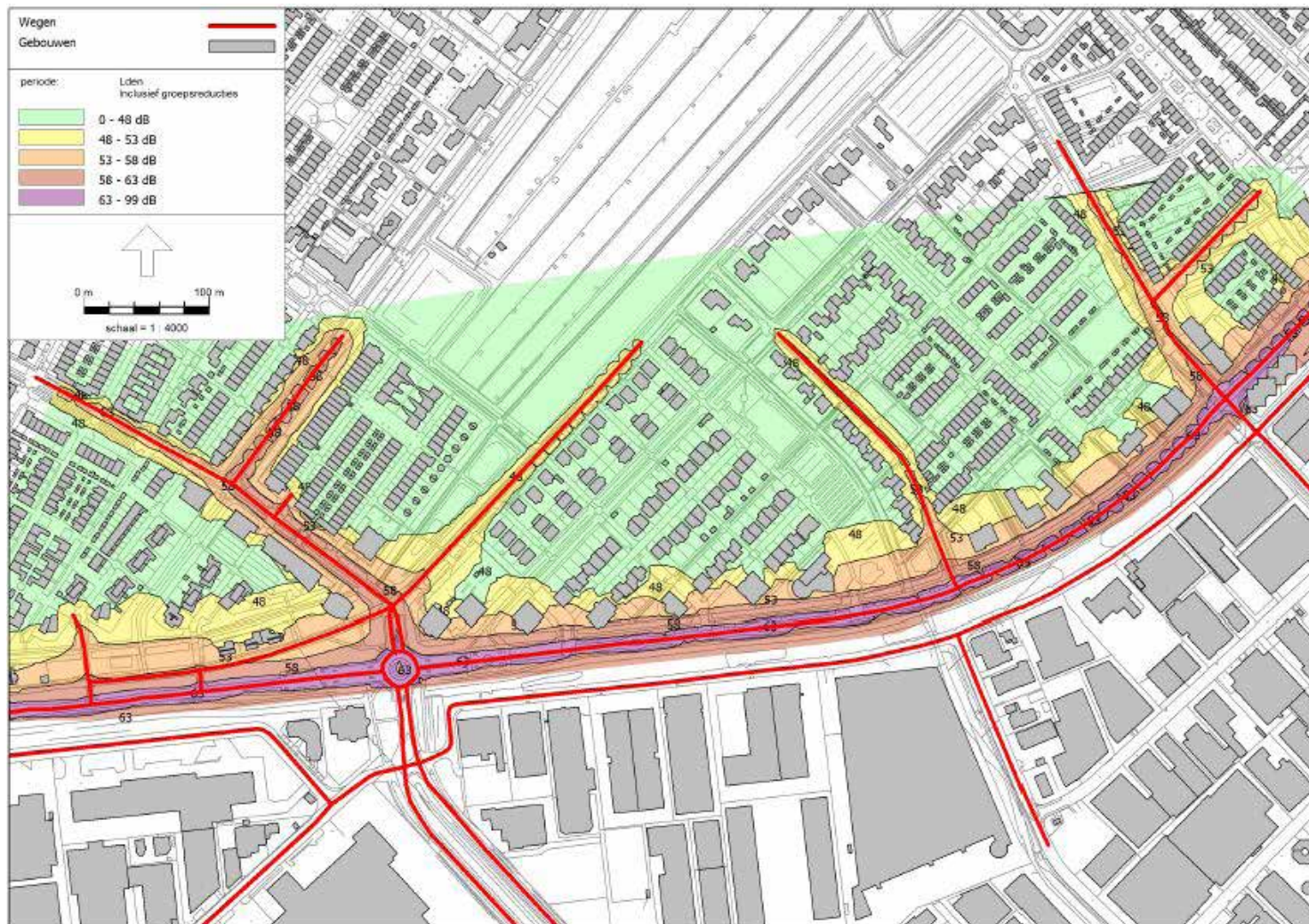
Figuur 22: Ter illustratie: Model verkeerslawaai 2035, geluidscontouren wegen totaal (hoogte 4,5 meter, niveaus inclusief 5 decibel aftrek).
